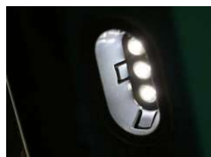
Iluminación interior, LEDs de bajo consumo
