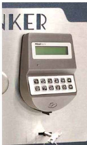
Cerradura electrónica de alta seguridad
