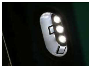
Iluminación interior, LEDs de bajo consumo
